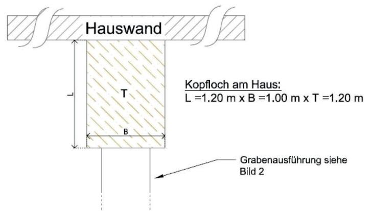
**Abbildung 3:** Draufsicht eines Kopfloches an der Hauswand
