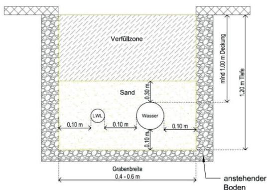
**Abbildung 2:** Schnittzeichnung Graben für Hausanschluss inkl. LWL-Rohr
